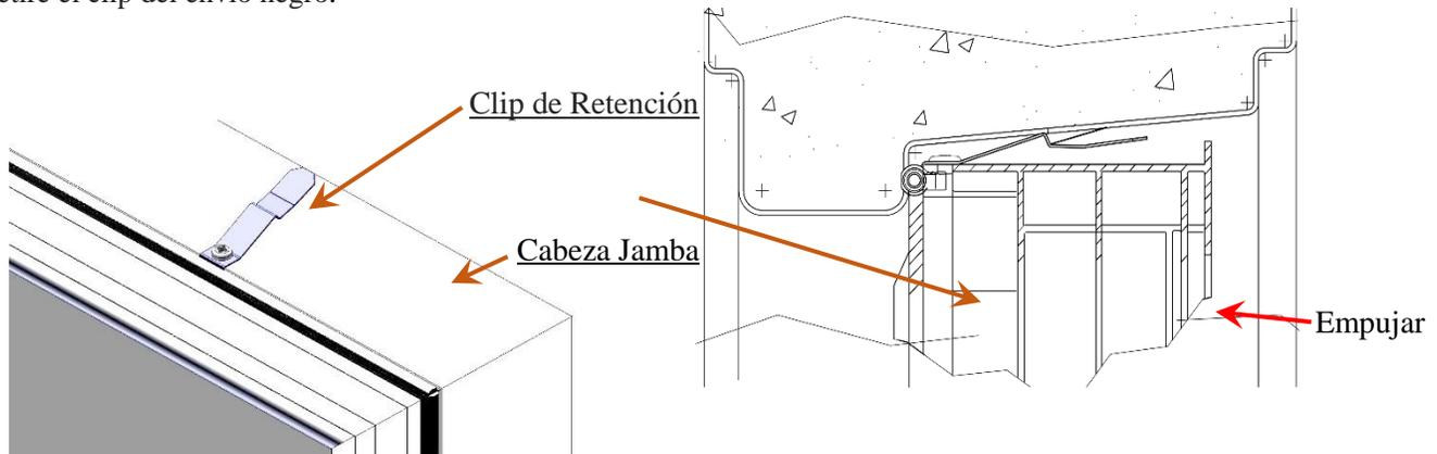
Dos (2) clips de retención preinstalado en la parte superior de la ventana VPro Bucko.
